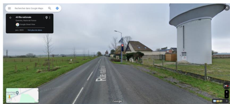
Feu récompense, double alimentation Eclairage public / solaire Capteur doppler + pied de feu
